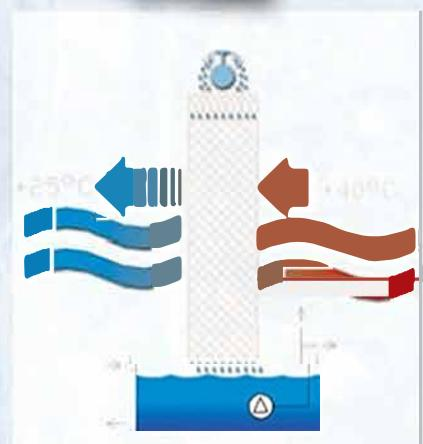
Şekil soğutucu petek sisteminin nasıl çalıştığını göstermektedir
